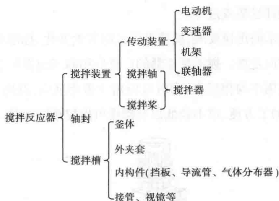
图 1.2 搅拌反应器结构分析图
