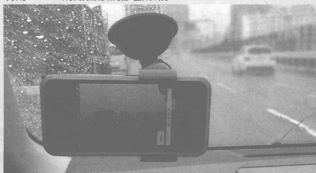
圖A 應用感測器與影像診斷路面劣化狀況 利用iPhone的路面狀況診斷系統
