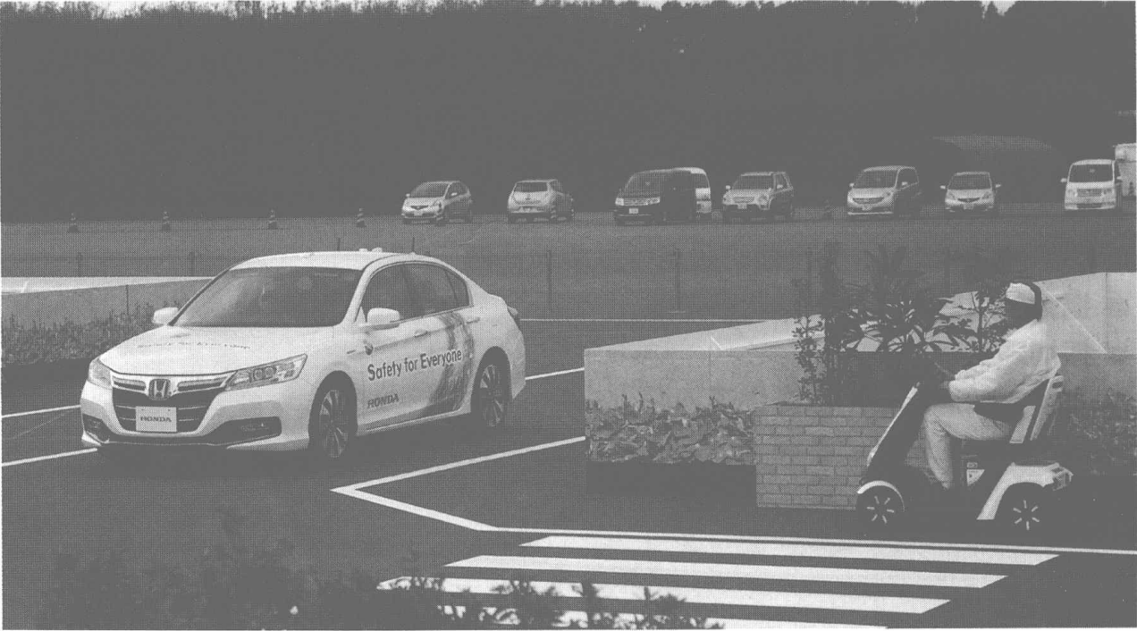
照片1 防止對撞於未然 日本本田汽車發表的新車。利用Wi-Fi與電動載運車通訊。可以檢知視野看不到之處的電動載運車
