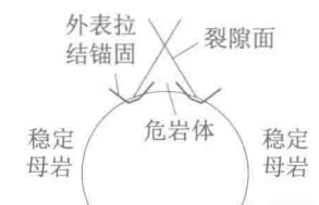
图9 地下开挖工程中的危岩外表裂隙拉结加固方式
