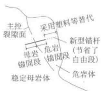
(b) 本文的内部裂隙拉结加固方法
