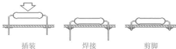
图 2-10 元件插装工艺顺序
