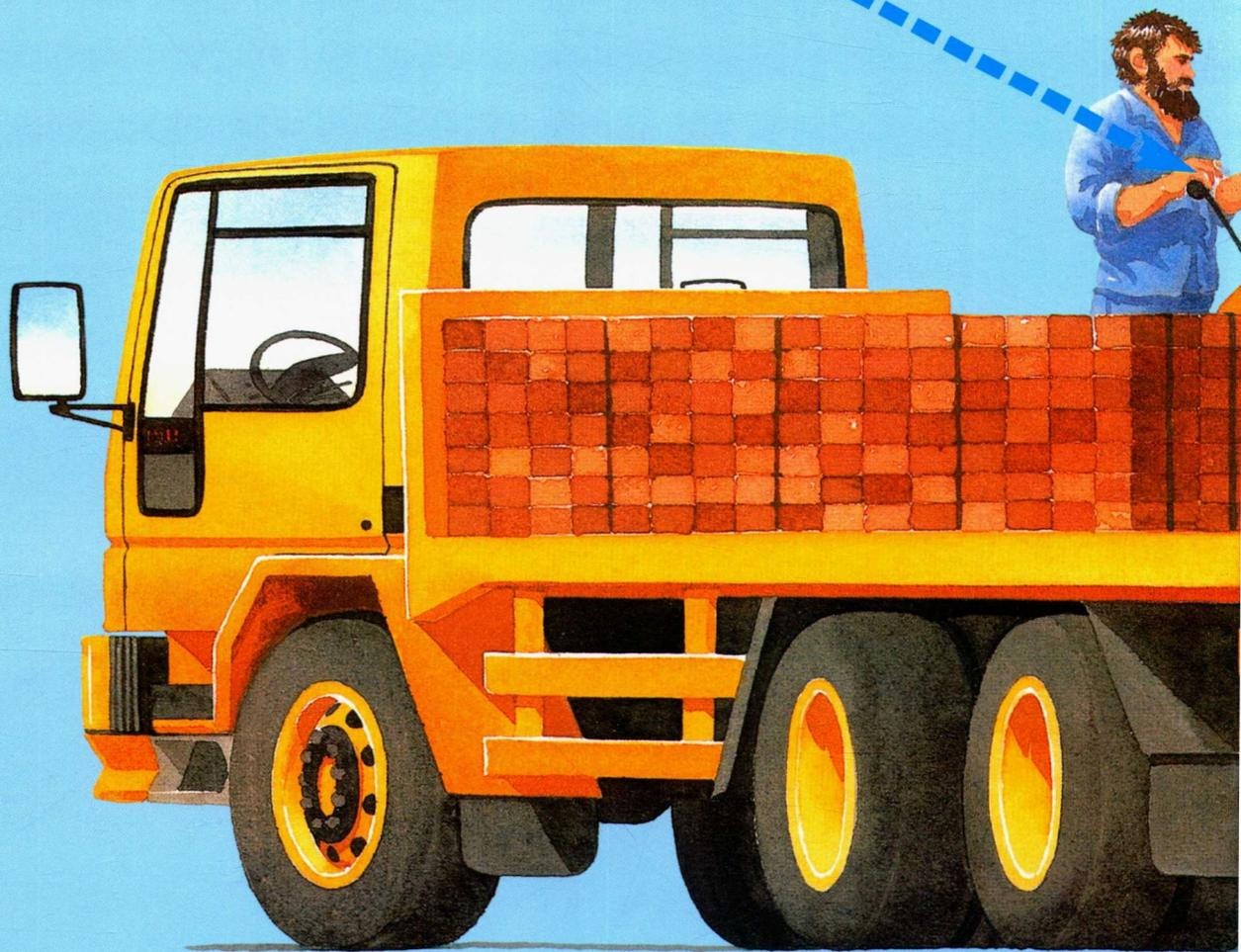
这辆平板卡车共有 10 个车轮。发动机的动力传递给后面的 8 个轮子，使车辆能够在崎岖泥泞的道路上行驶。
