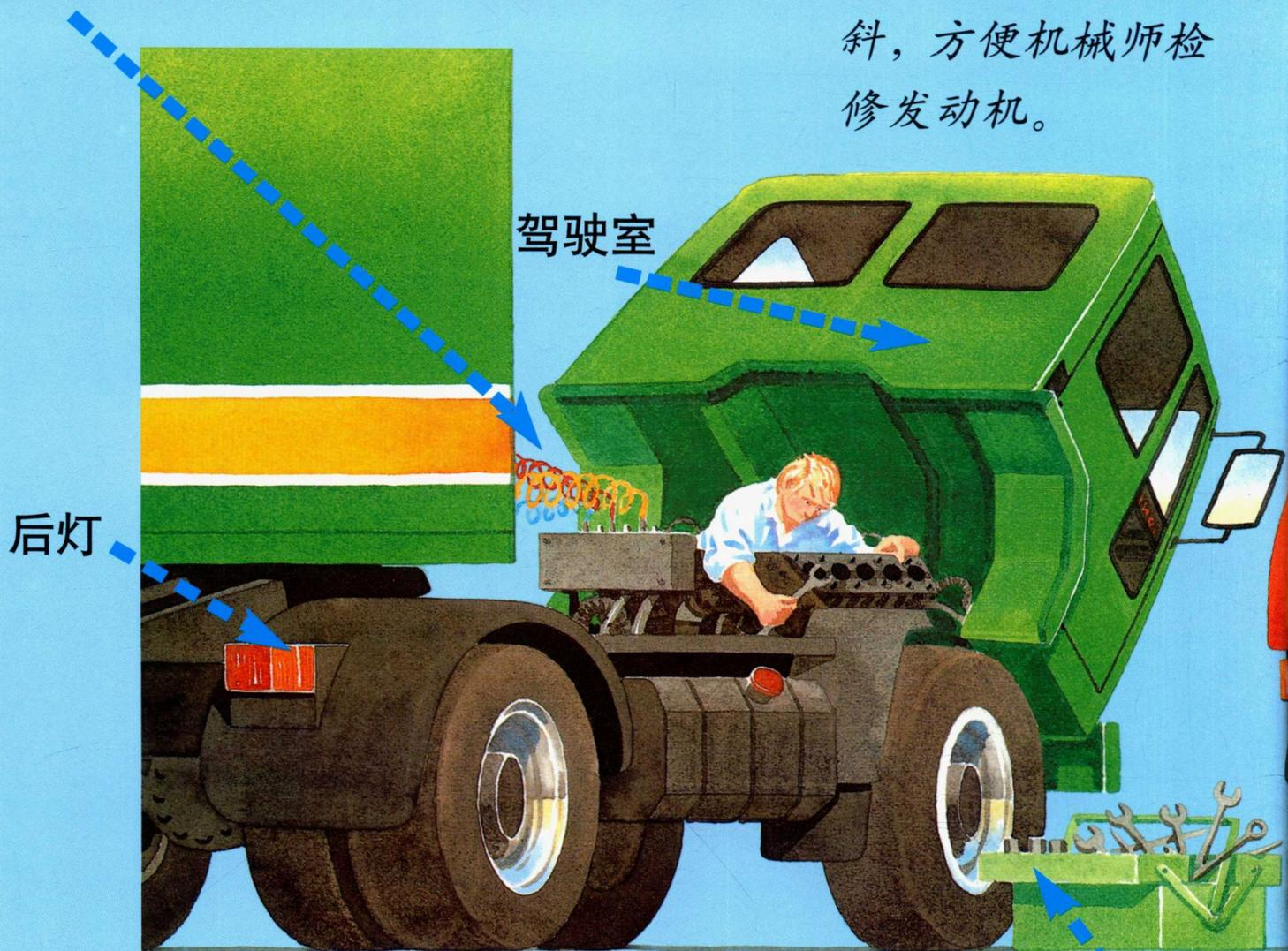
机械师必须准备一个完整的工具箱，以便能在路上修理卡车。他们还得清楚不同的发动机应该如何拆开并重新组装起来。
