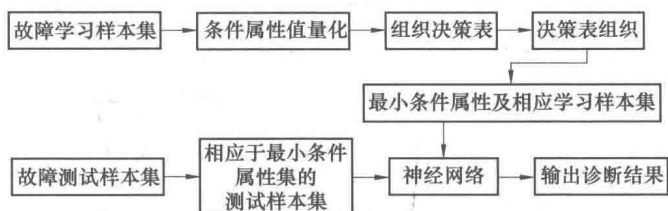
图 1-2 粗糙集—神经网络故障诊断系统框图
