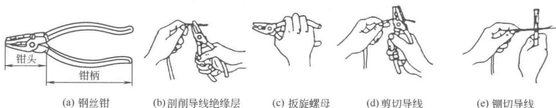
图 1-2 钢丝钳构造及其使用方法
