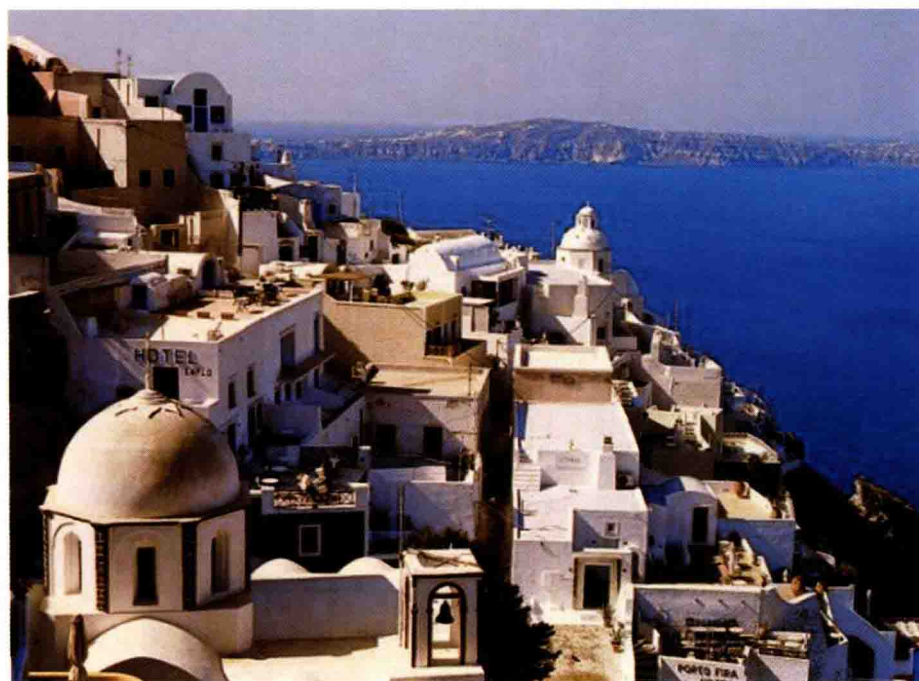
图1-19 希腊的地中海建筑，白色涂料外墙表面具备反射强烈日照的作用
