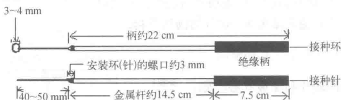
图1-3 接种环结构示意图
