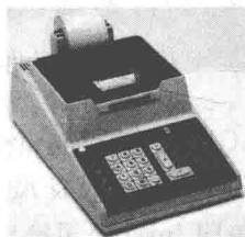
图 1.8 1971 年,Intel 推出的 4004 CPU 图 1.9 采用 Intel 4004 CPU 的 Busicom 141-PF 计算器
