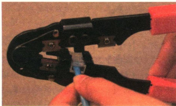
图 1-1-5 用压线钳压紧水晶头的金属压片
