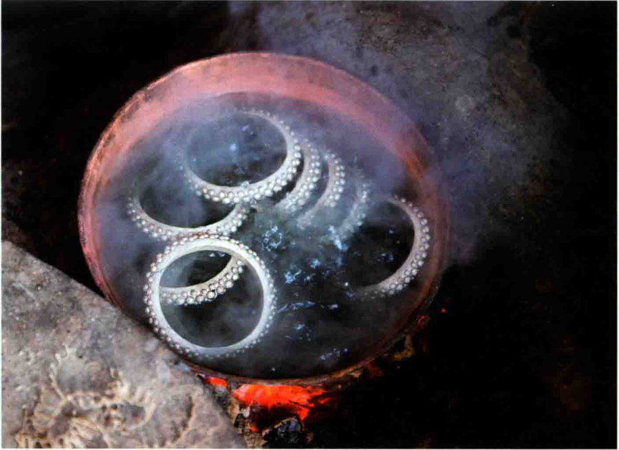
图 25 将银手镯放入酸性液体中清洗
