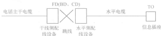
图 1-6 电话交换系统中对绞电缆与配线设备间的连接方式
