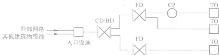
图 1-4 综合布线系统引入部分构成
