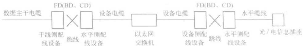
图 1-7 交叉连接方式（经跳线连接）
