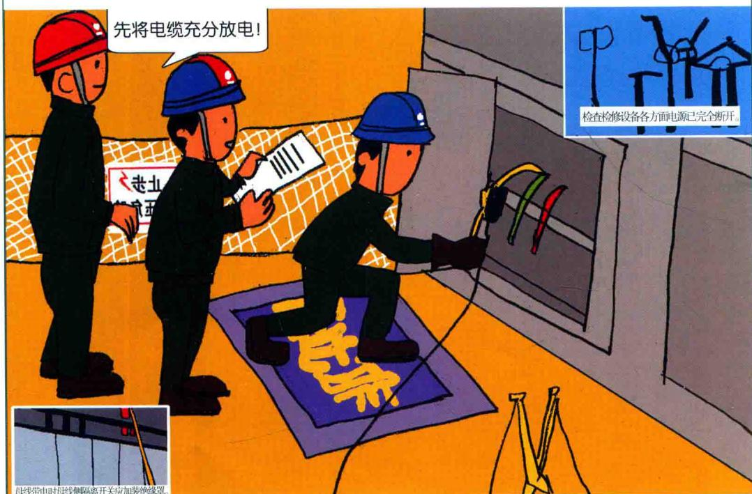
**控制措施一：**作业前检查检修设备各方面电源已完全断开（含设备的控制电源及操作电源），工作设备与带电部分各侧有明显断开点、可能来电的各侧和检修设备已接地（开关柜内隔离开关与带电设备之间宜采用绝缘罩或绝缘隔板）。
