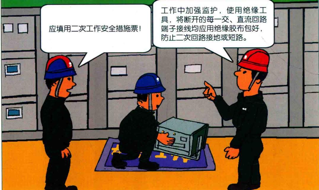
**控制措施一：**工作前检查可能造成运行设备误动的保护压板确已停用，并在压板上采取隔离措施（如主变压器保护联跳高、低压侧分段开关保护压板）；将工作的保护屏上可能造成其他运行设备误动的二次连线解开。
