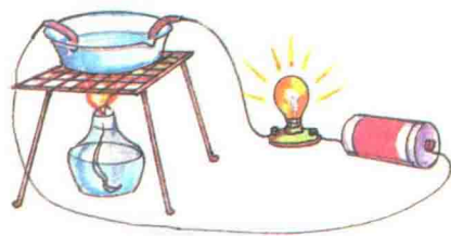
图 1-3 熔化状态导电性试验装置
