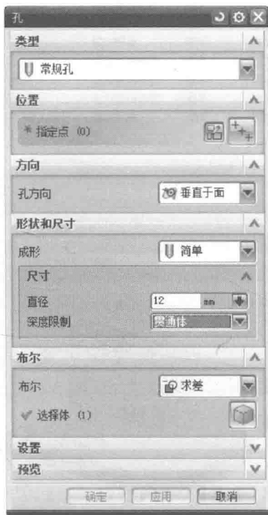
图 1-7 选择长方体上表面为孔的放置平面
