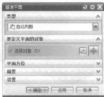
图 1-6 创建两个面的二等分基准平面
