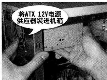
图 1-3 安装主机电源
