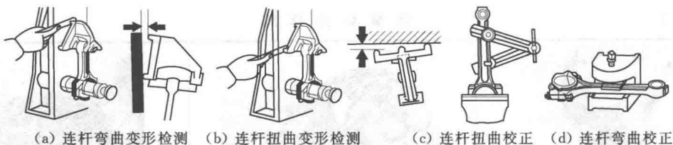
图 2.1 连杆的检验与校正
