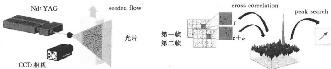
图 1.4 PIV 设备测速流程
