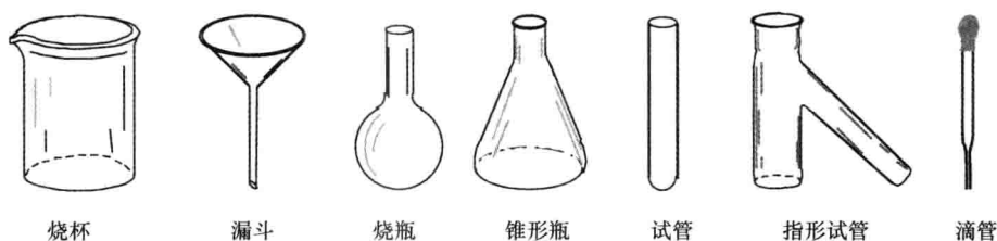
图 2-1 基础化学实验常用玻璃仪器
