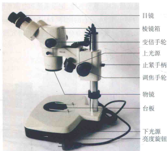
图 1-2 体视显微镜的构造
