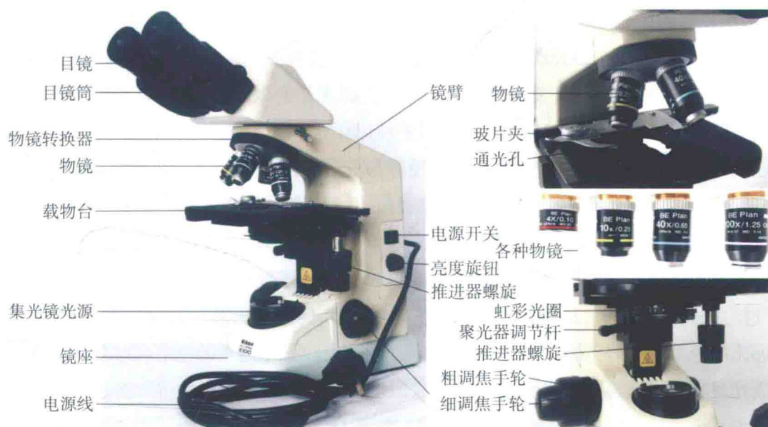
图 1-3 普通光学复式显微镜的构造
