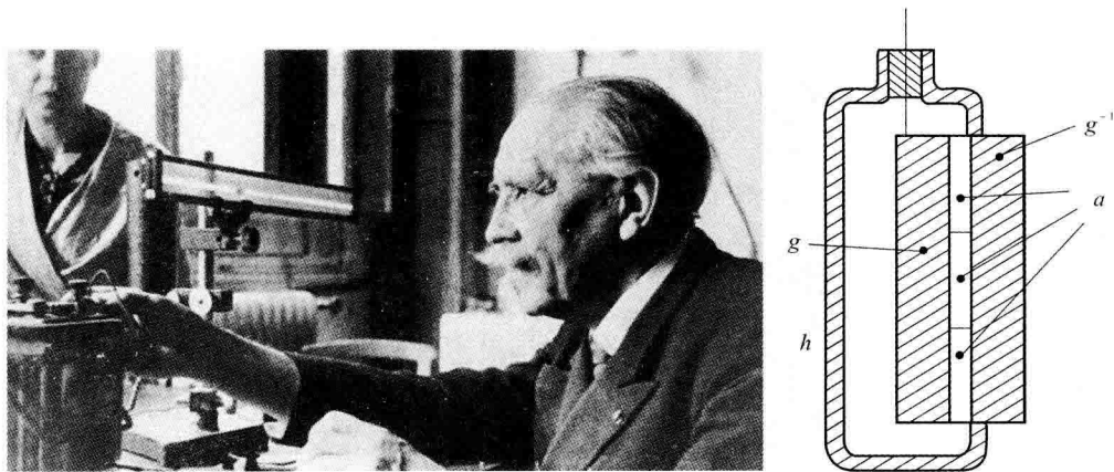
图 1-3 法国科学家 Paul Langevin 及其发明的石英换能器 (British Patent 145,691, July 28, 1921)
