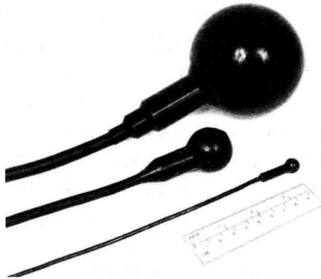
图 1-15 球形换能器实物
