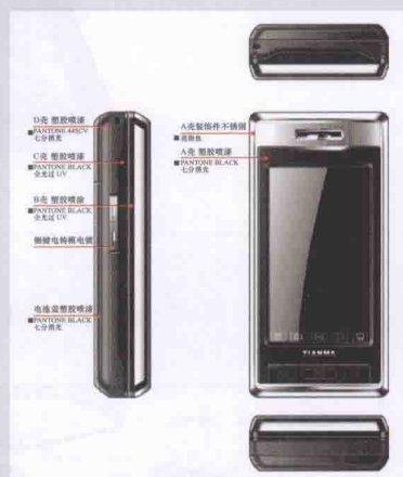
► 图 24-4 左视图、正视图的工艺标注
