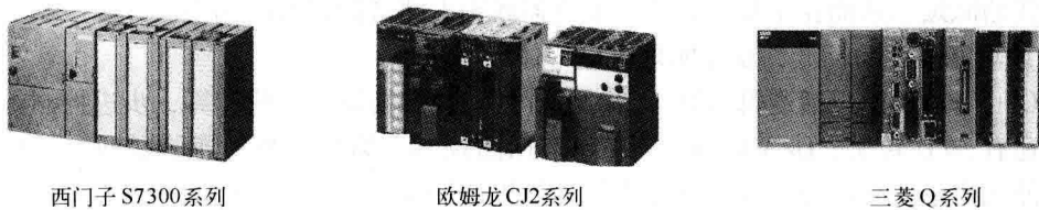
图 1-2 模块式 PLC 示例
