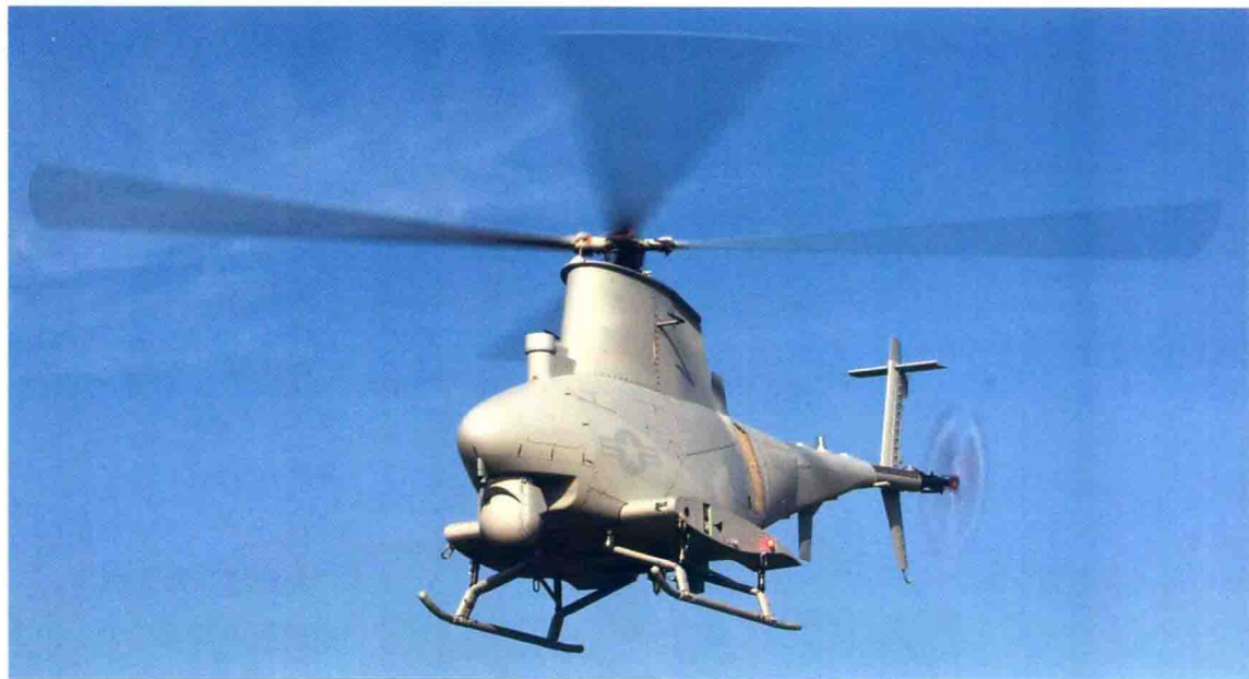
MQ-8“火力侦察兵”无人直升机，这是典型的旋翼无人机。
