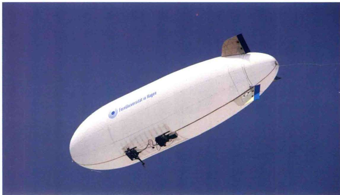
能够远程遥控的无人飞艇，下方无载人吊舱。
