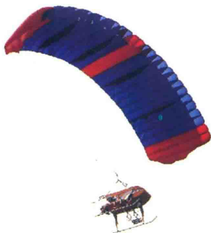
伞翼无人机，采用伞翼加挂推进吊舱的形式构成。
