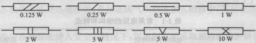
图 1-13 非线绕电阻器额定功率符号
