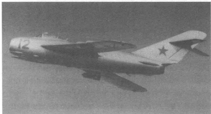
一架苏联米格-17F。注意它的气泡式座舱盖（这能够为飞行员提供良好的后向视野）以及机翼挂点处的炸弹，北越的米格-17通常在这些位置携带副油箱。（杰伊·米勒拍摄）
