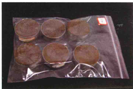
图 2-5 直剪试验环刀样品
