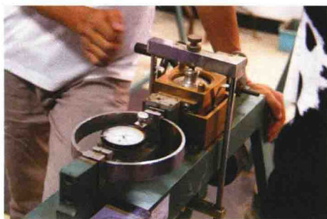
图 2-6 泥化夹层重塑样直剪试验示意图
