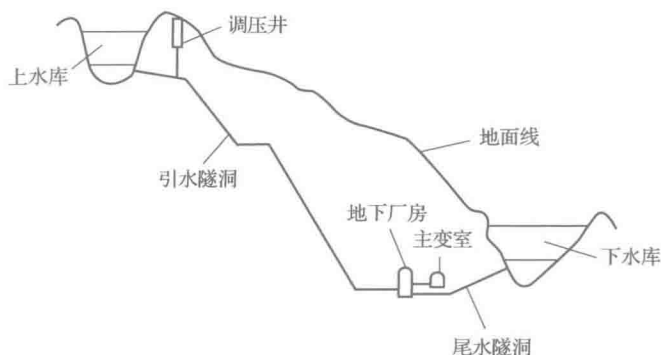
图 1-2 纯抽水蓄能电站示意图
