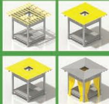
建造屋面、屋顶时，两者的结构原材料分别加工组装成型，再架设到建筑的横梁上。组装完毕后，装上板材，做好地板和天花板，并装上竹子。
