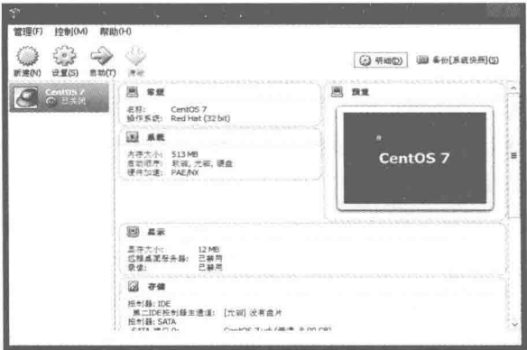
图 1-3 在 virtualbox 安装 CentOS 7 Linux 系统
