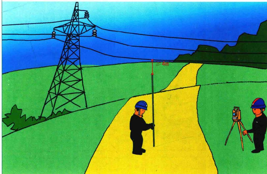
**控制措施一：**立塔尺前要认真观察导线对地距离，塔尺抽出长度不得超高，严格保持与带电导线的安全距离。
