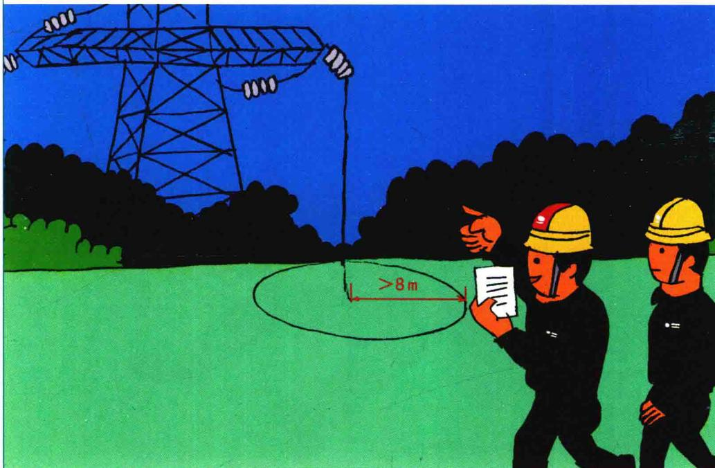
**控制措施一：**故障巡线时，应由两人进行，并配备防护用品，穿绝缘鞋或绝缘靴。
