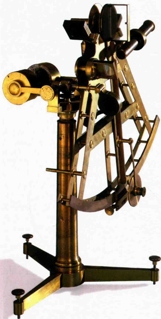
下图：这是一架19世纪的黄铜六分仪——配有三脚架和伸缩可视镜——可通过测量正午的太阳或夜晚某个合适的星星的高度来确定纬度。
