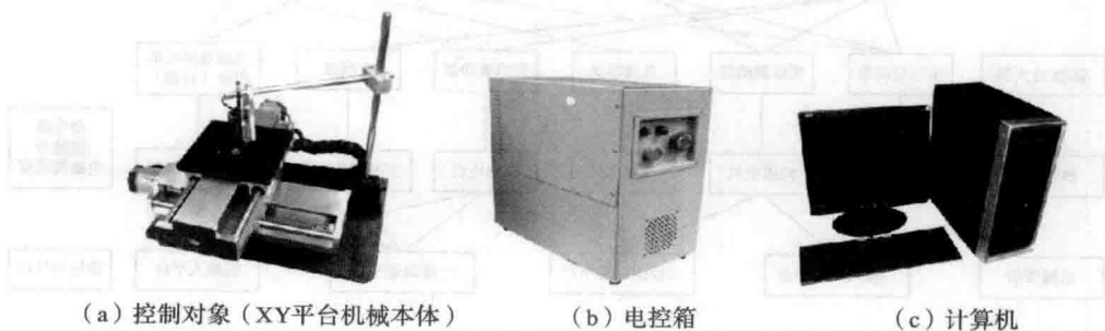
图 1.4-1 XY 平台系统组成
