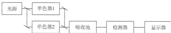
图 2.3 双波长分光光度计光路示意图
