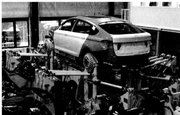
图 1-4 MTS 公司设计研制的多轴 329 系统试验台 [14]
