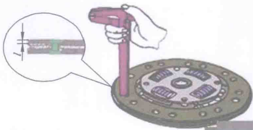
图 1.20 摩擦片磨损程度的检查
