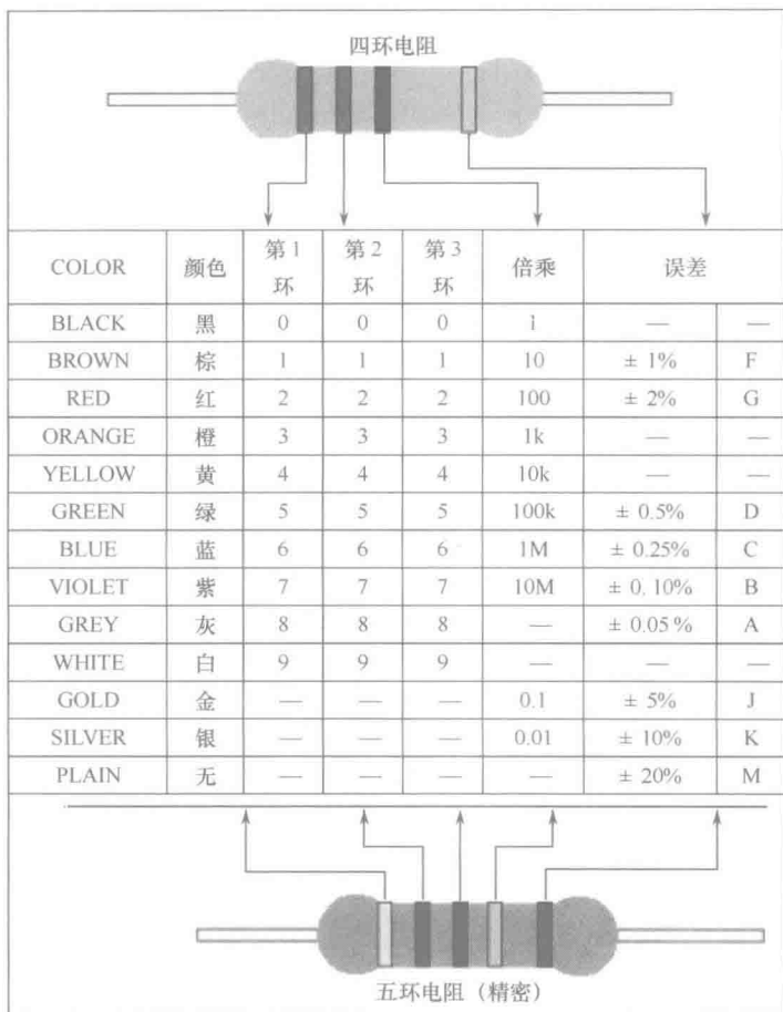
图 1-8 电阻的色环阻值表示法示意图
