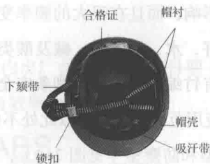
图 2-2 安全帽结构示意图
