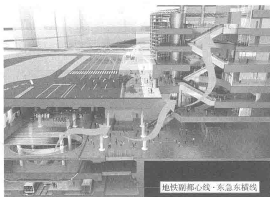
图 14 涩谷站综合体 Hikarie 列车风换气系统
