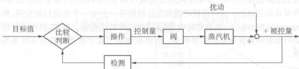
图 1-3 闭环控制信号的传输方式
