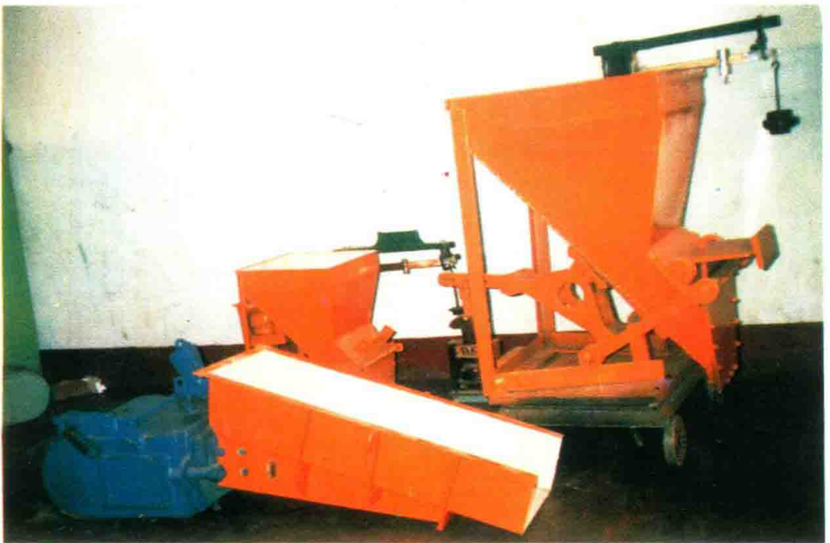
襄阳县一中无线电厂生产的程控配料秤和喂料机
