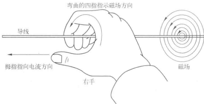
图 1.3.4 电流流过导体会产生磁场
