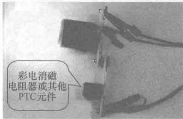
(a) 热敏电阻器(PTC)冷时电阻很小
