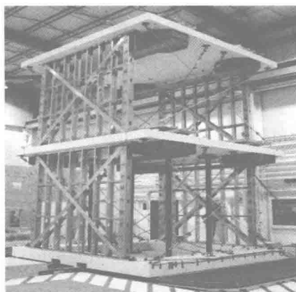
图 2 足尺模型振动台试验 [33]
