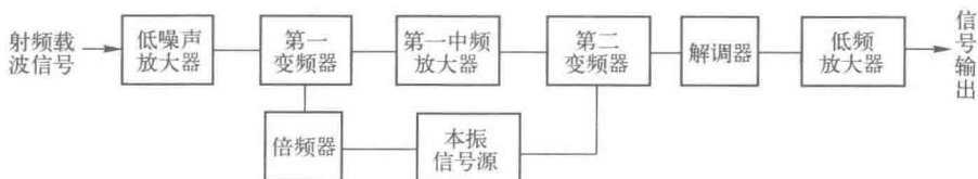
图 1-3 一种短波收信机的组成框图
