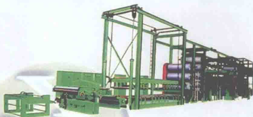
XY-4Γ 1730 橡胶压延 (恒张力1.5 t) 生产线
