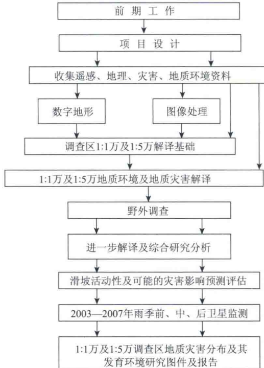
图 1-1 帕里河滑坡卫星遥感调查工作流程
