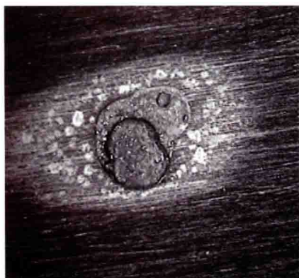
(a) 金属表面第6次干燥后表面状态
