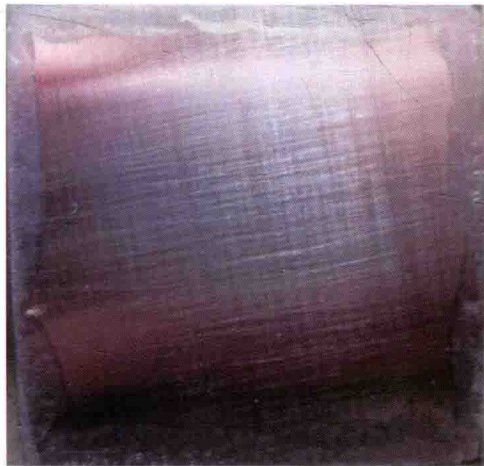
图 7-29 碳钢表面涂抹酚酞试液后图片（见 209）
