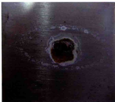
(b) 金属表面第9次干燥后表面状态
