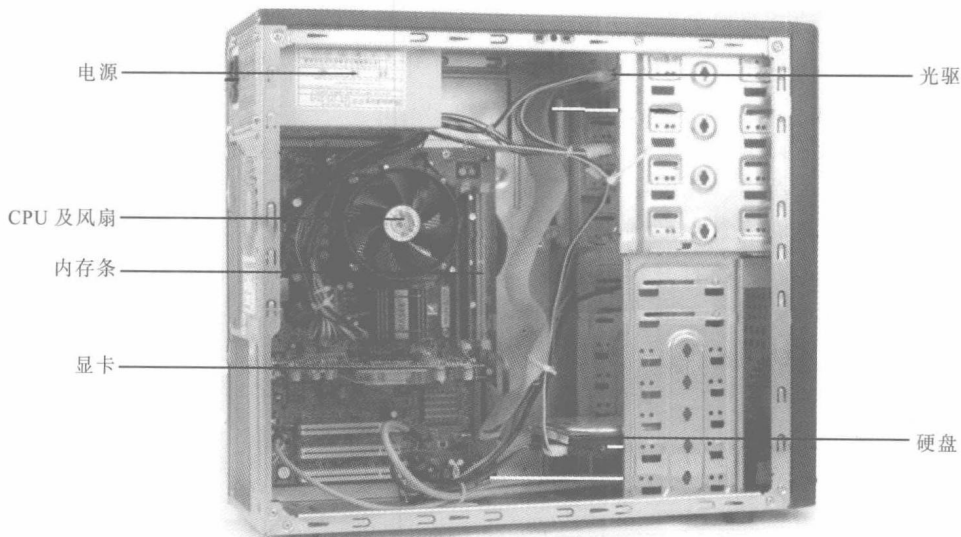
图 1-4 主机箱的内部图
